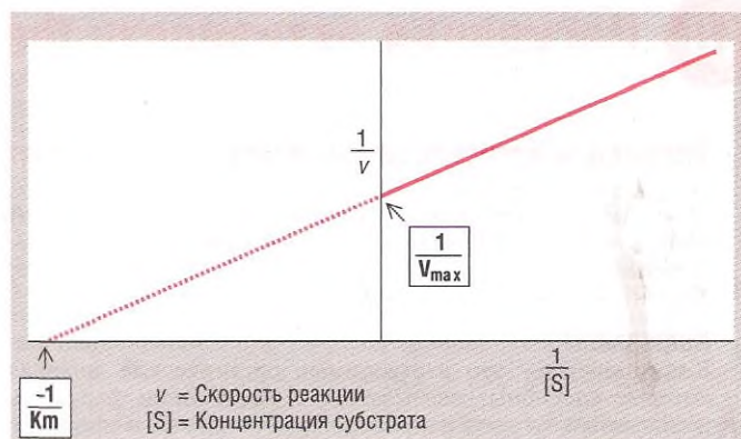
Рис. 9.3. График фермента Лайнуивера–Берка (график Михаэлиса–Минтен в обратных координатах).
